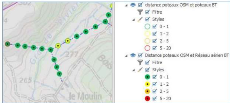
Exemple 3 : Poteaux OSM et poteaux BT existants en cohérence (écart < 0,5m)
