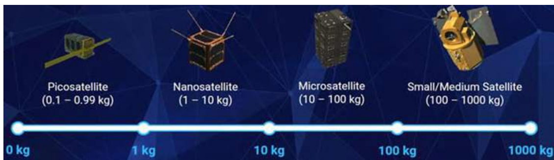
Figure 1-3-2-8 – Comparaison des tailles de satellites
