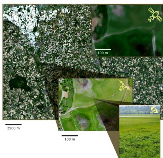
Figure 1-3-2-14 – Comparaison des résolutions en fonction de la source de l'image
